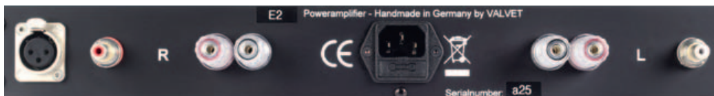
Buchsen und Klemmen mit Silberauflage ergänzen die interne 4N-Silberverdrahtung mit „Solid Core“-Leitern im Signalweg. Der Netzschalter sitzt etwas versteckt im Boden unterhalb der Frontplatte.
