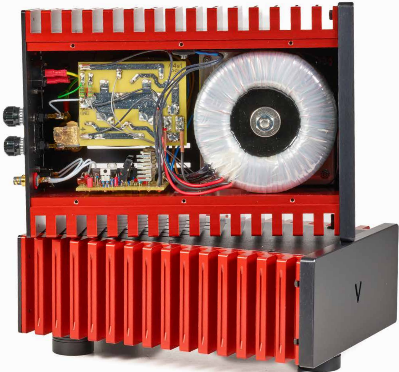
Die Eingeweide werden vom 500-Watt-Ringkerntrafo dominiert. Direkt an die roten Kühlkörper angedockt, erkennt man die beiden Leistungstransistoren. Der Leitungsstrang der Kabel besteht aus reinem Silber. Sehr vertrauenerweckend!
